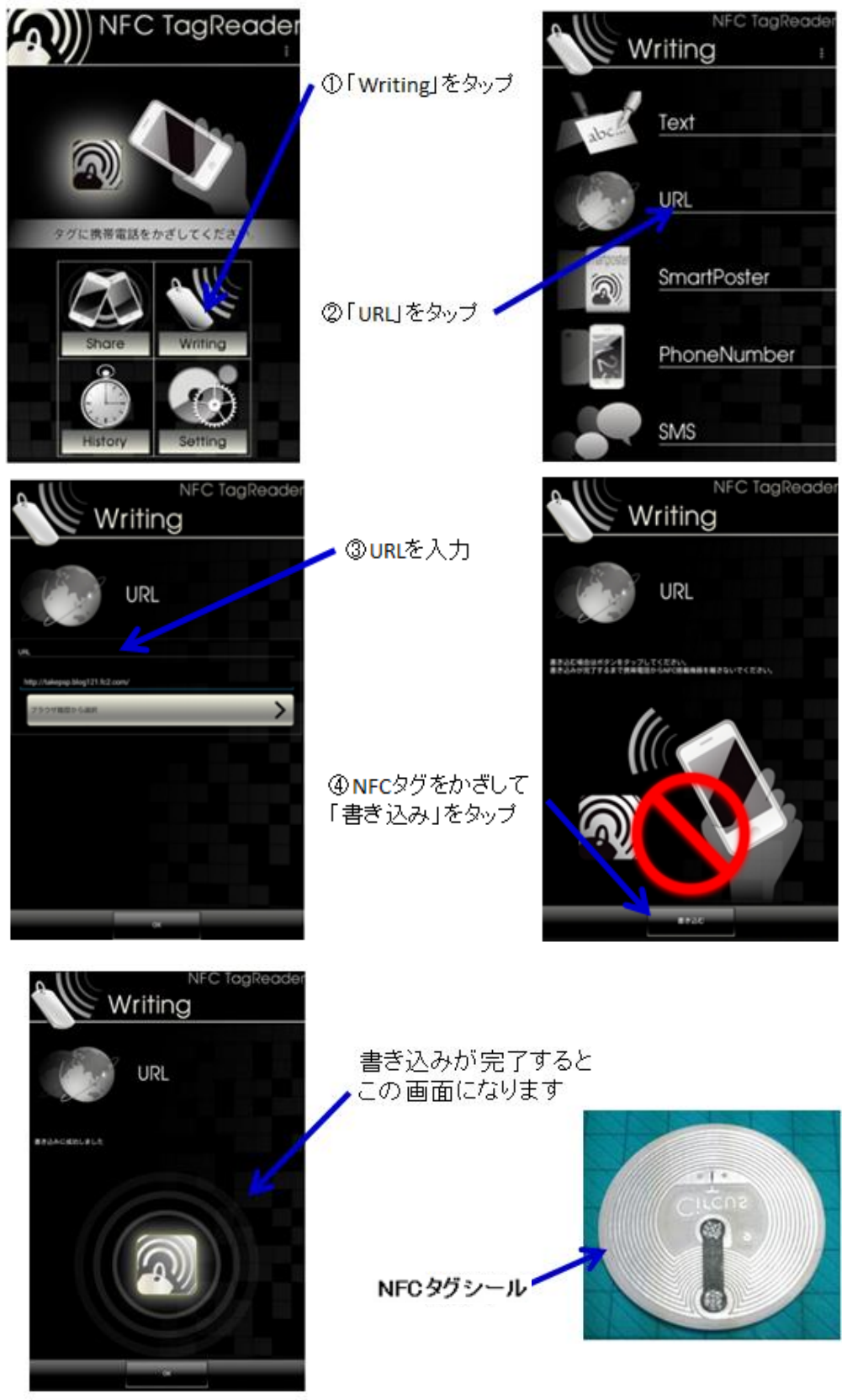
図.5 NFC タグリーダーによる NFC タグシールの作り方
